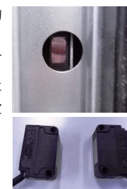
サイドフレーム内 障害物センサー
